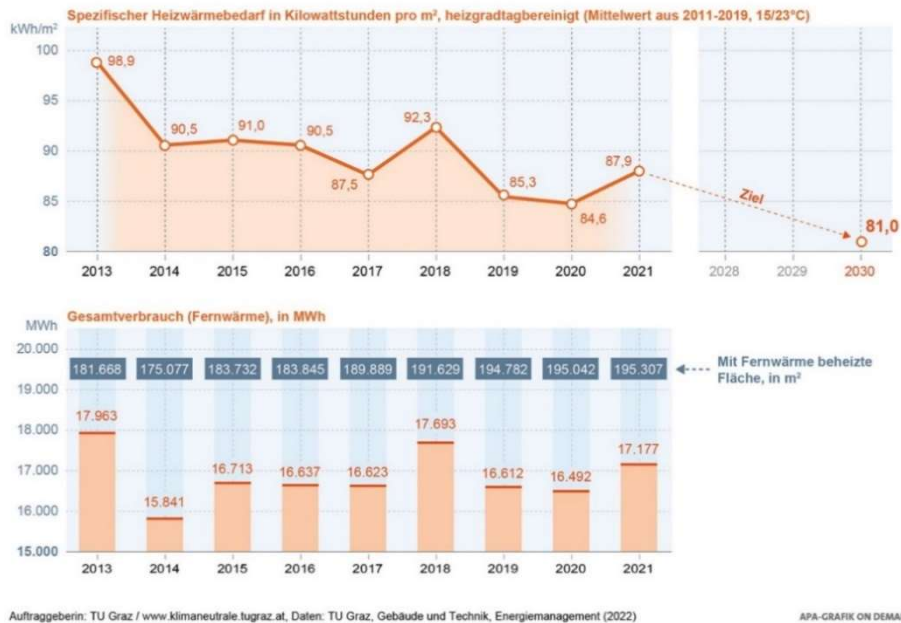
Abbildung 35: Heizwärmebedarf (Fernwärme) TU Graz 2013-2021 und Zielwert 2030
