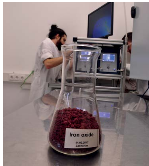
Abbildung 4: Materialforschung zur Verbesserung von Reaktivität und Stabilität der eingesetzten Kontaktmasse.
