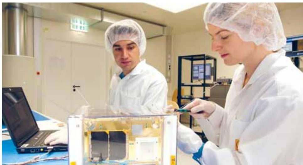
Patrick Romano und Manuela Unterberger mit TUGSAT-1 im Reinraum an der TU Graz. Der Nanosatellit wurde an der TU Graz entwickelt, gebaut und getestet
