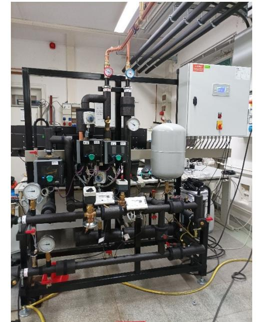
Abb.: links: Versuchsstand bestehend aus Wärmenetz-Emulator (1), bidirektionaler Wärmeübergabestation (2), Pufferspeicher (3) und Gebäude-Emulator (4); rechts: bidirektionale Wärmeübergabestation
