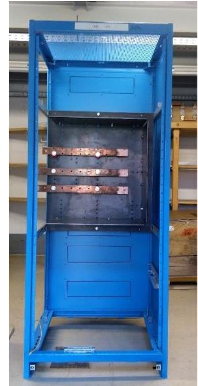
Bild 2: Sammelschienen-Versuchsanordnung in Schaltschrank
