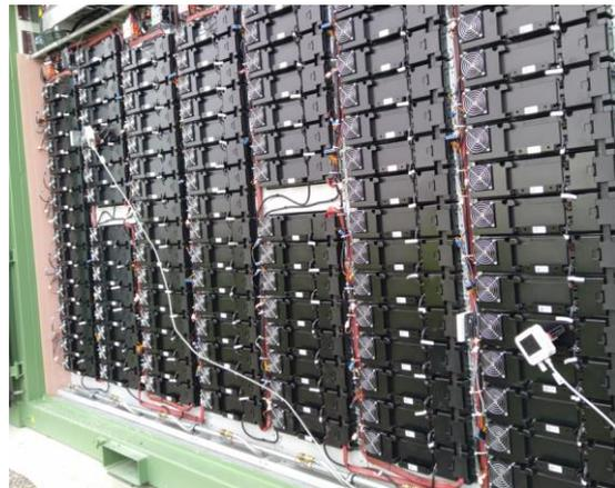
Abbildung 5: Temperatur- und Luftfeuchtesensoren
