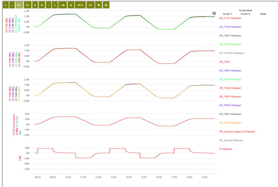
Abbildung 8: Leistungsverlauf bei einem Kapazitätstest 3\*Entladen; 2\*Laden
