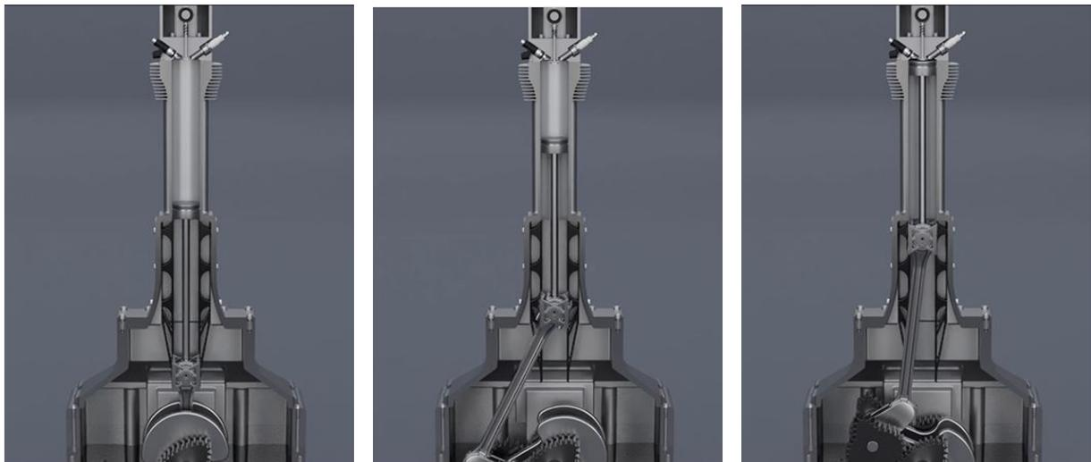
Abbildung 4: *Wenn das Auslassventil zu Beginn des Ausschiebetaktes öffnet, ist das Arbeitsgas soweit entspannt, dass kein wesentlicher Abgasknall mehr wahrnehmbar ist. Die Abgase sind mit ca. 200°C relativ kühl.*
