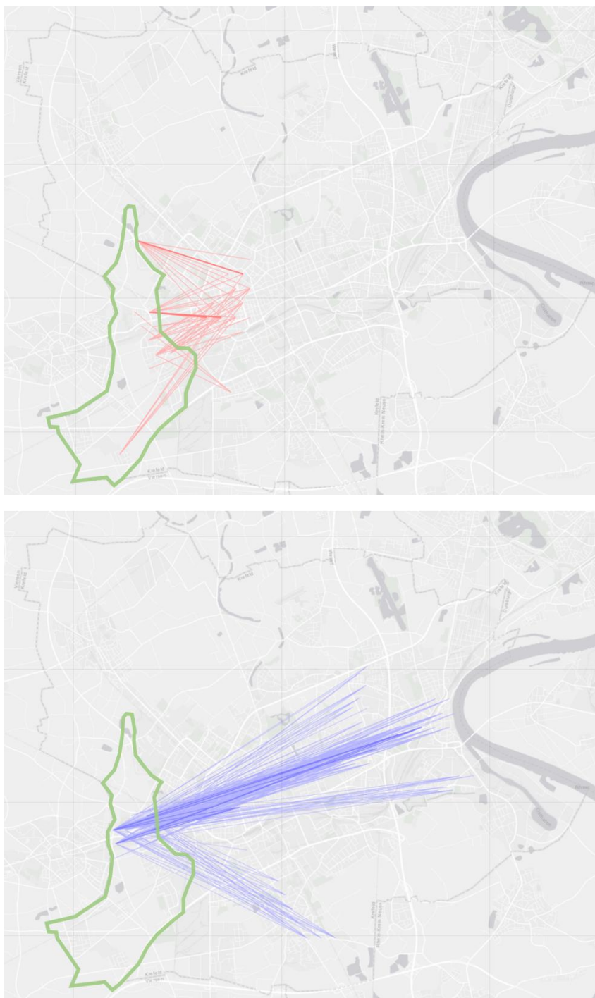
Abbildung 5: Ergebnisauszug: Bewertete Relationen mit Start im PLZ-Gebiet 47804 (grün) und Ziel in Krefeld zwischen 9 und 10 Uhr. Oben in Rot: viele Personen, hoher Widerstand; Unten in Blau: wenig Personen, geringer Widerstand.
