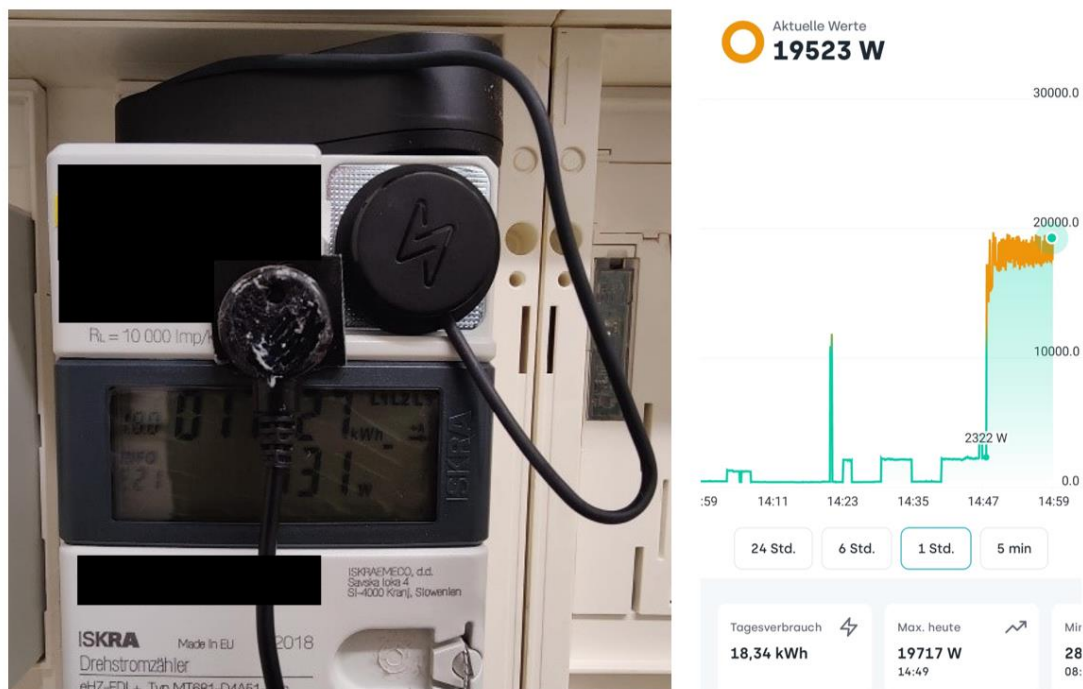
Abbildung 3: Links: Messaufbau mit beiden Systemen aus Feldtest 2, rechts: Visualisierung in Smartphone-App
