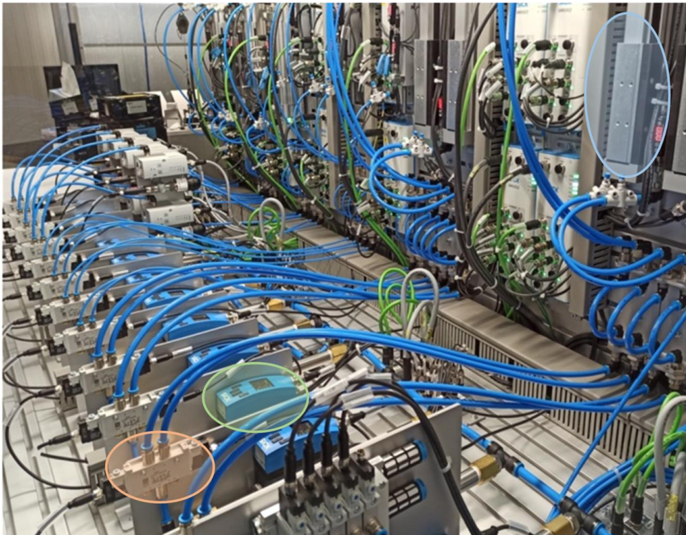
Bild 4: Druckluftdemonstrator (Ventil in orange, Durchflusssensor in grün, Aktor in blau). Foto: Fraunhofer IPA
