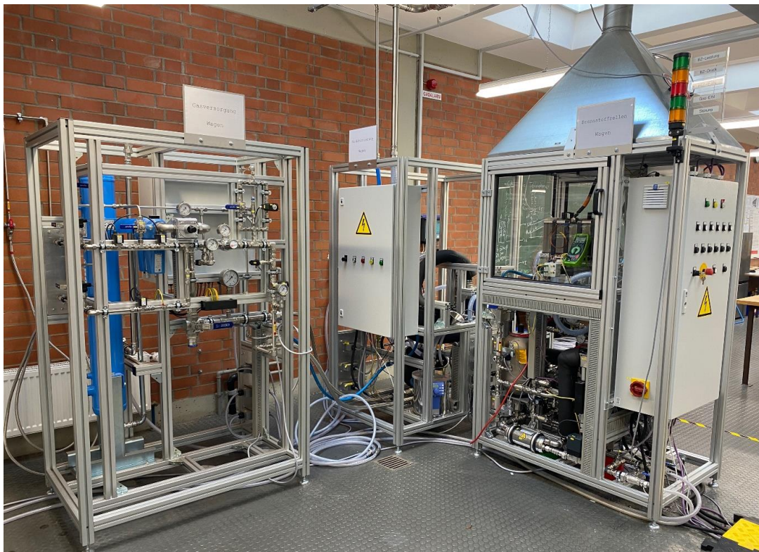
Abbildung 1: Versuchsstand mit drei Gestellen (von links nach rechts): Gasversorgungsgestell, Konditionierungsgestell, Brennstoffzellengestell.
