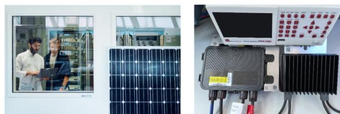
Abbildung 4: Bisher sind im ZHAW IEFE Labor die oben angeführten Wechselrichter und Optimizer vermessen worden. Dabei wurden wie im Normalbetrieb im Kraftwerk typisch 10 Optimizer in Serie betrieben und an den Eingang des DC/AC Wandlers geschaltet. Von jedem einzelnen Optimizer, wurden die Verluste über die zwei Eingangs- und die zwei Ausgangsanschlüsse mit dem PPA1500 gemessen, siehe Bild von zwei Optimizer Typen rechts unten. [13]
