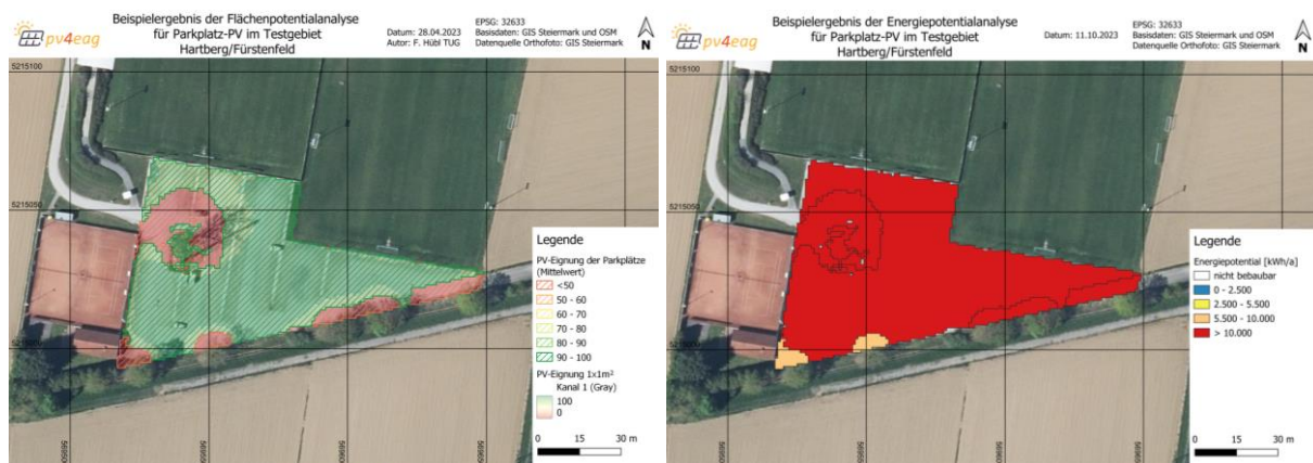
Abbildung 3: Ermittelter Flächen- und Energiepotential von Parkplatz-PV
