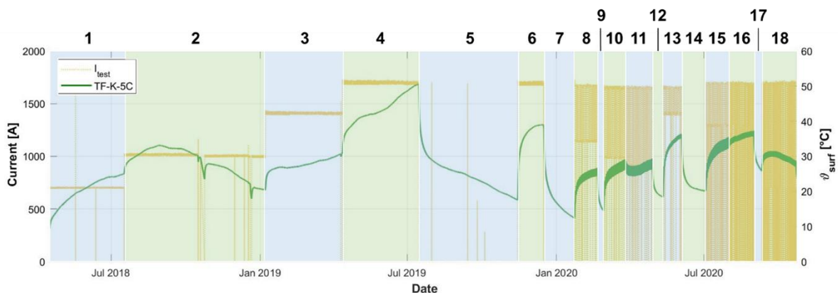
Abbildung 9: Teilung der Daten nach Belastungsszenarien für die Validierung (load fold validation)
