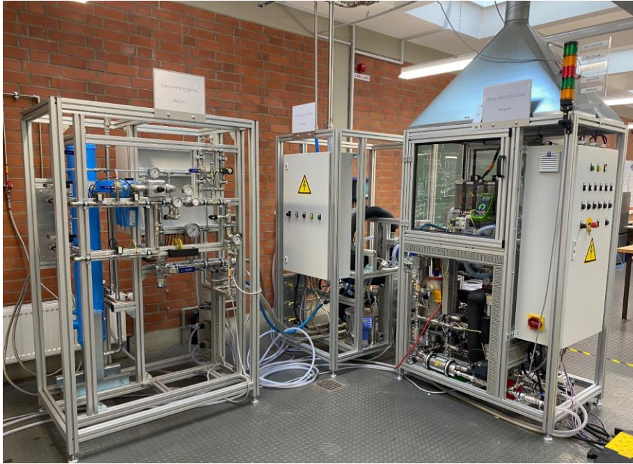
Abbildung 1: Versuchsstand mit drei Gestellen (von links nach rechts): Gasversorgungsgestell, Konditionierungswagen, Brennstoffzellengestell.
