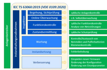
Abb. 2: Mapping: IEC63060→Schutztechnik
