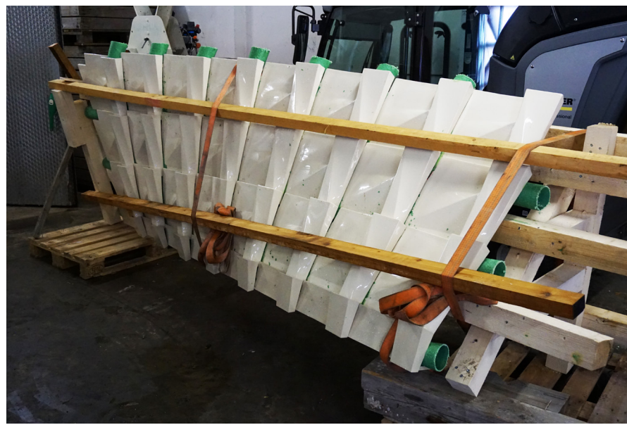
In der Werkstatt werden die Keramikelemente zuerst verklebt und dann in zwei Schritten mit Faserbeton vergossen.
