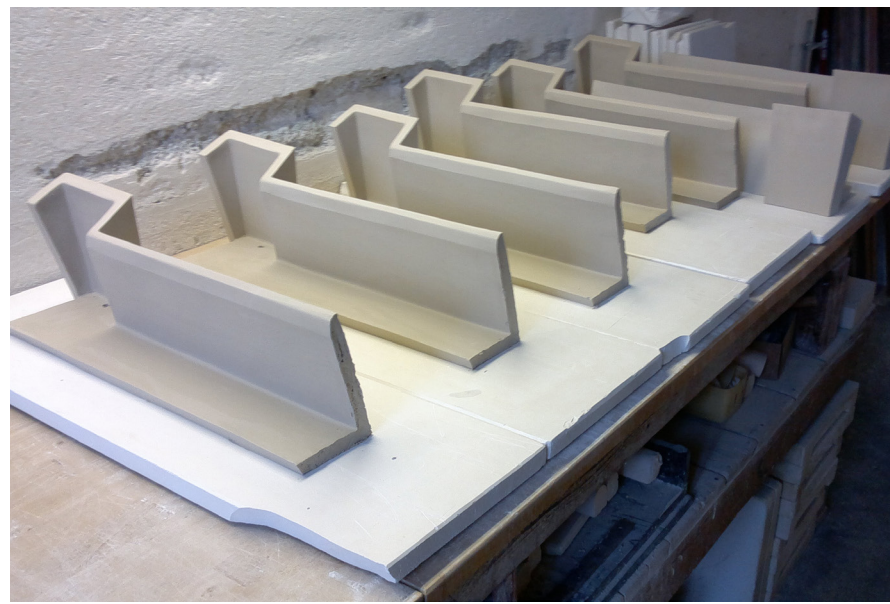
Produktion der Keramikelemente im Schlickergussverfahren mithilfe von Gipsformen. Das Fügekonzept folgt dem Prinzip der Überlappung.
