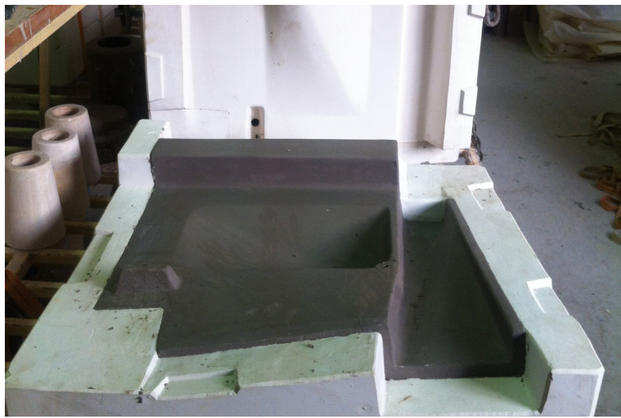
Produktion der Keramikelemente im Schlickergussverfahren mithilfe von Gipsformen. Das Fügekonzept folgt dem Prinzip der Überlappung.
