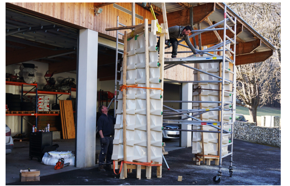
Tests im Labor für Konstruktiven Ingenieurbau der TU Graz geben Hinweise auf das Tragverhalten von Faserbeton in Verbund mit den Keramikelementen.
