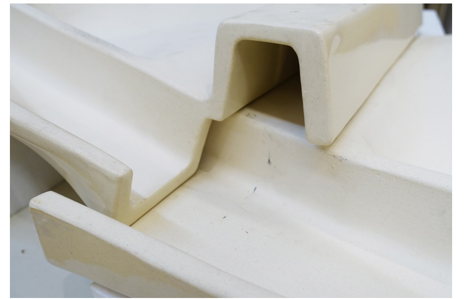
Produktion der Keramikelemente im Schlickergussverfahren mithilfe von Gipsformen. Das Fügekonzept folgt dem Prinzip der Überlappung.
