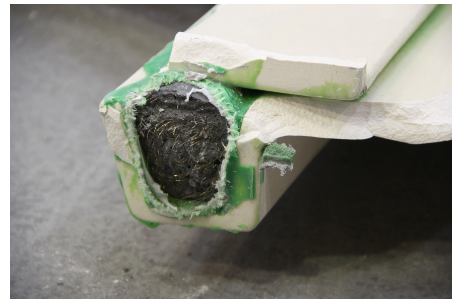
Tests im Labor für Konstruktiven Ingenieurbau der TU Graz geben Hinweise auf das Tragverhalten von Faserbeton in Verbund mit den Keramikelementen.
