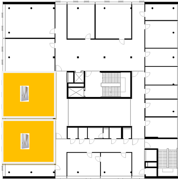
Abbildung 29: Grundriss 6. OG des Use Cases mit Darstellung der Test-Raumregelzonen (gelb markiert)
