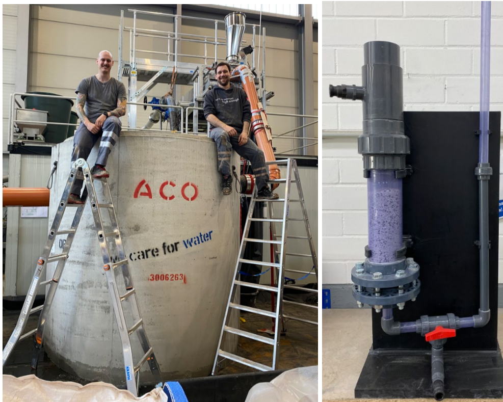
Abbildung 2: Die Autoren auf dem Teststand des IKT zur großtechnischen DIBt-Prüfung zur AFS-Entfernung / Schwermetallsäulenversuch (privat)
