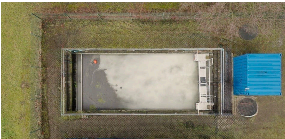
Abbildung 1: Einsatz des Prototyps (Minimal Viable Product – MVP) zur Mikroflotation in einem bestehenden Regenklärbecken zur Elimination von AFS und Mikroplastik.
