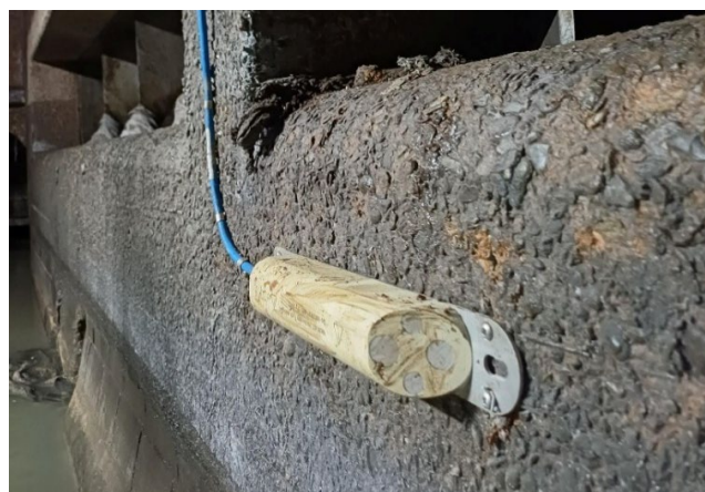
Abbildung 1: Frachtmessung an einem Entlastungsbauwerk im Mischwasserkanal mit dem NIVUS PKM-Sensor.
