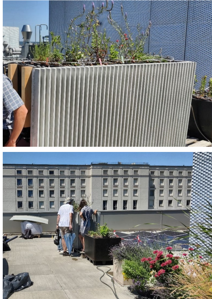
Abbildung 1: ReWass Pflanzbehälter, Prototyp HTW Dresden mit unterschiedlicher Bepflanzung (Juli 2025).
