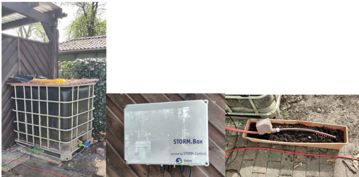
Abbildung 5: Test für STORM.Box an einem IBC-Container mit Bewässerung aus dem Ablauf des Carports.
