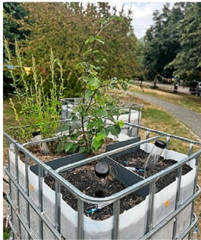
Fig. 4 Pilot-Baumrigole mit verschiedenen Deckschichten von Oberboden mit/ohne Zusatz von BC oder BAC im Masseverhältnis 1:4.
