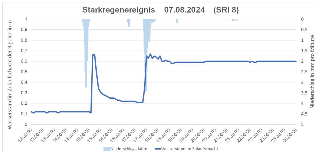
Abbildung 3: Messergebnisse des Ultraschallmessgerätes während des Starkregenereignisses am 07.08.2024 (SRI 8).
