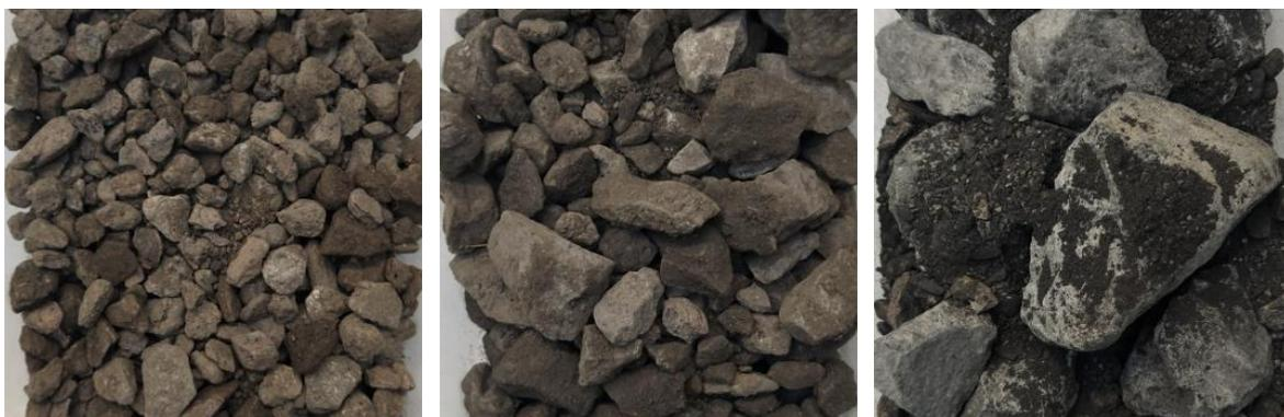
Abbildung 37: Drei Pflanzsubstrate, die in der Stadt Zürich für Baumrigolen eingesetzt und im Labor auf deren Schadstoffrückhaltevermögen untersucht wurden. Von links nach rechts: A1, A1 und B (vergleichbar mit Stockholm-Substrat).
