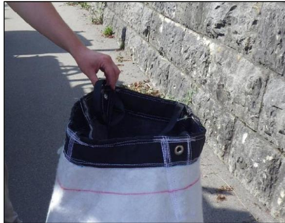
Abbildung 2: Oberer, verstärkter Teil des GTS mit 4 Kauschen zum Einhängen an die Tragkonstruktion
