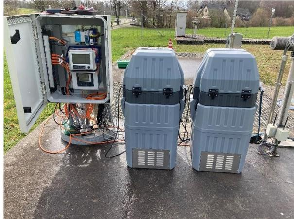
Abbildung 9: Probenahmeequipment zur Beprobung der Mischwasserentlastung: Zwei MAXX Probenehmer (gesteuert über Pegelsonde), Datenlogger, Modem für Fernzugriff.
