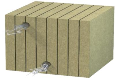
Anlagenaufbau mit Rockflow-Steinwolle, mit Wasserzufuhr und Entlüftung mittels gefräster Rohrkanäle
