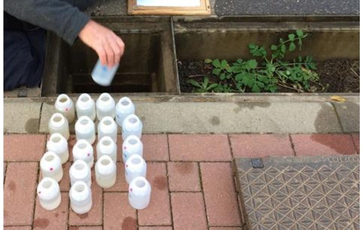
Untersuchung auf Filterkurzschlussgefahren bei starkem Regenwurmbesatz an Rinnenfiltern im Altbestand
