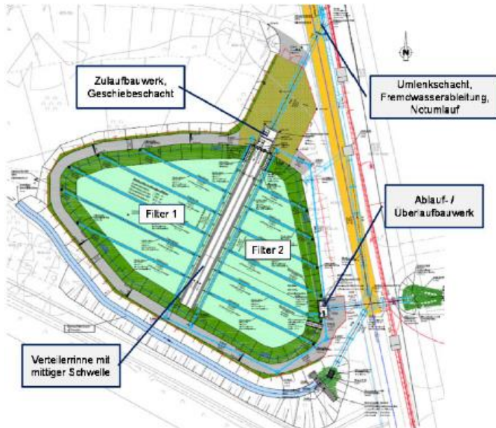
Abbildung 3-1: Lageplan Retentionsbodenfilteranlage Plettenberg
