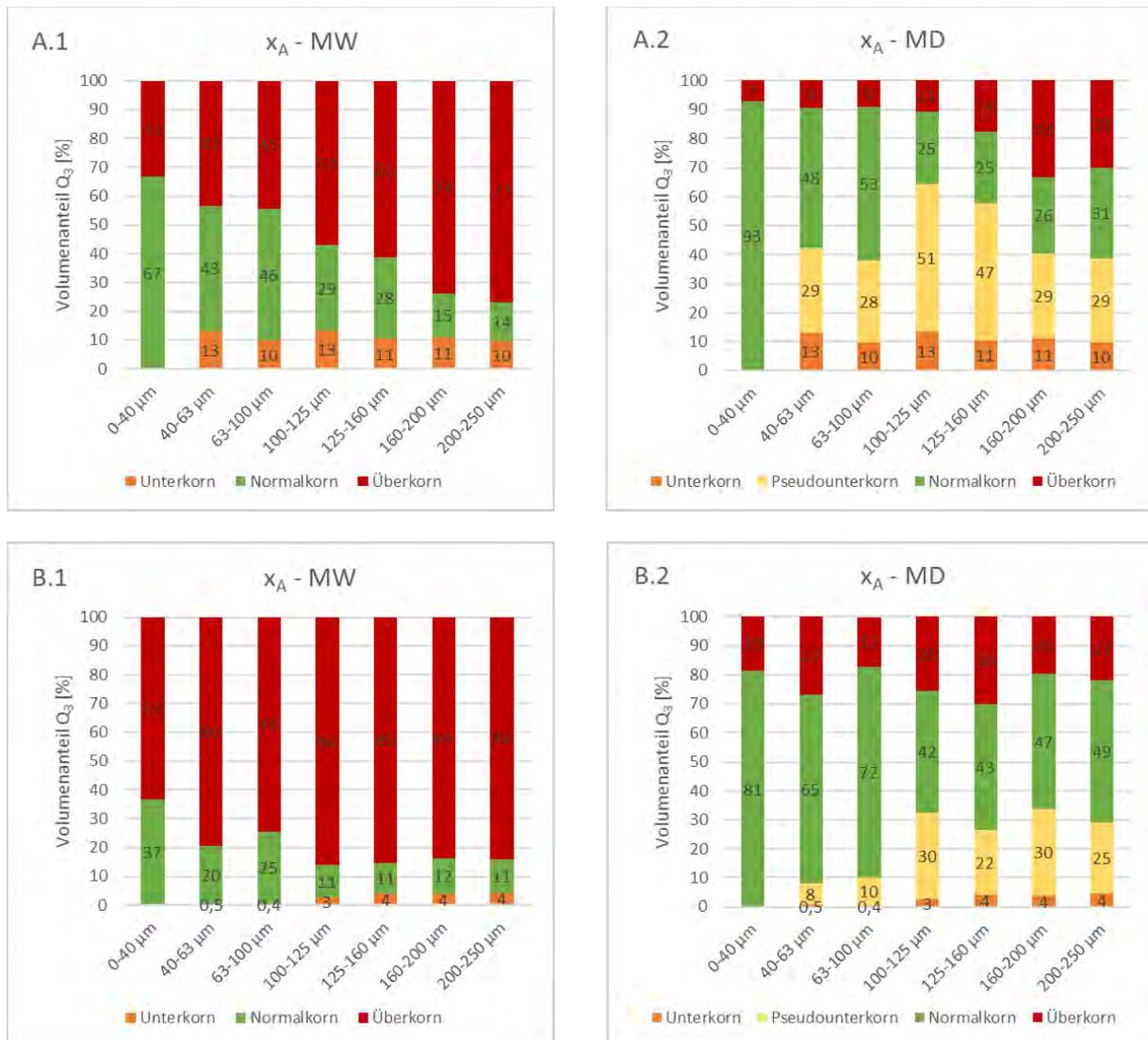
Abbildung 60 Normal-, Unter-, Pseudunter- und Überkornanteile der Einzelfraktionen S8 (A (oben): DIA dynamisch; B (unten): DIA statisch) beim 2D-Deskriptor  $x_A$  und der Auswertemethode nach Maschenweite (MW, links „1“) und Maschendiagonale (MD, rechts „2“)
