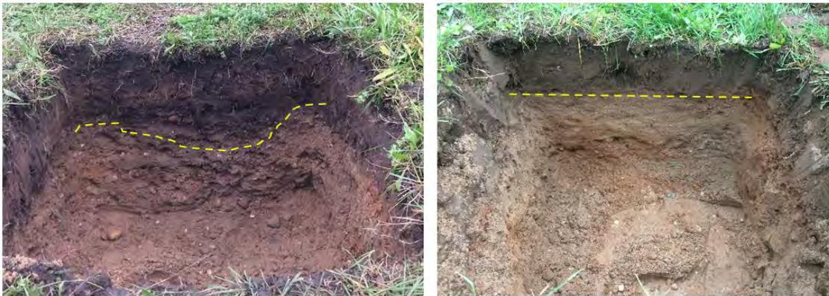
Abbildung 3: Bild (l) mit optisch erkennbarer Tiefenverlagerung 4 m vom Zulauf 2, während im Bild (r) in 50 m Entfernung ein trennscharfer Übergang in 0,30 m Tiefe vom Ober- zum Unterboden vorliegt
