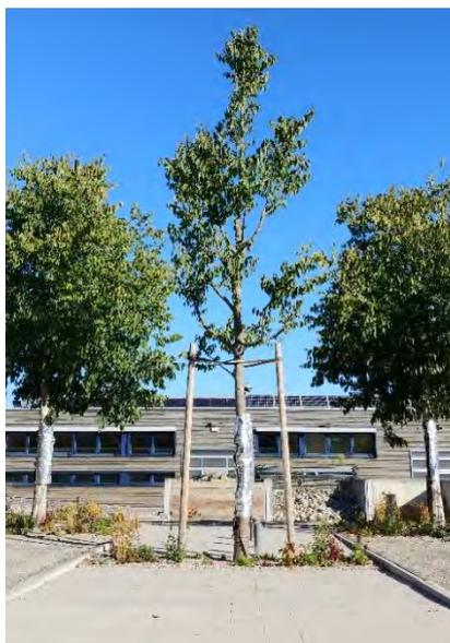
Abbildung 28: Schwammstadt-Lysimeter in der Jägerhausgasse in Wien im Oktober 2020
