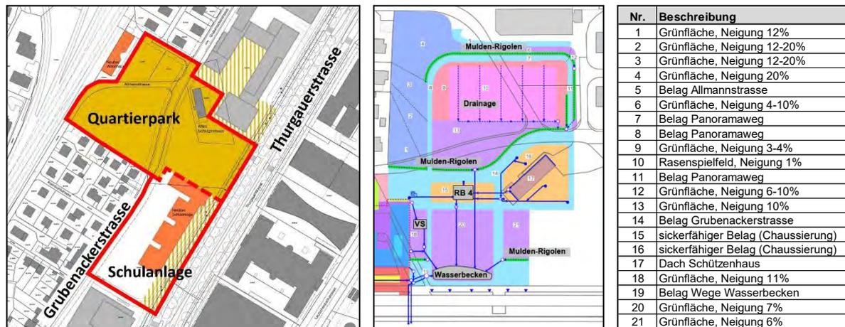
Abbildung 74: Projektperimeter Quartierpark (links) und Schema Entwässerungssystem (Mitte/rechts)
