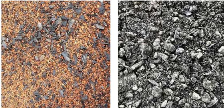
Abbildung 54: Nicht überbaubare Pflanzsubstrate mit Ziegelschrot und roher Pflanzenkohle (links) und mineralisches Substrat mit kompostierter Pflanzenkohle (rechts; INKoh<sub>soil</sub>). ©Burkhardt, Saluz.
