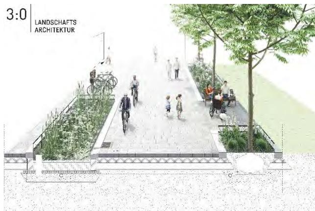
Abbildung 6: Schnittperspektive durch Duales Tiefbeet und Schwammstadtkörper
