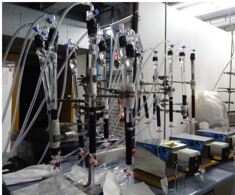
Abb. 1: Versuchsaufbau – Versuche mit zwei verschiedenen Eisenhydroxiden – je acht Säulen
