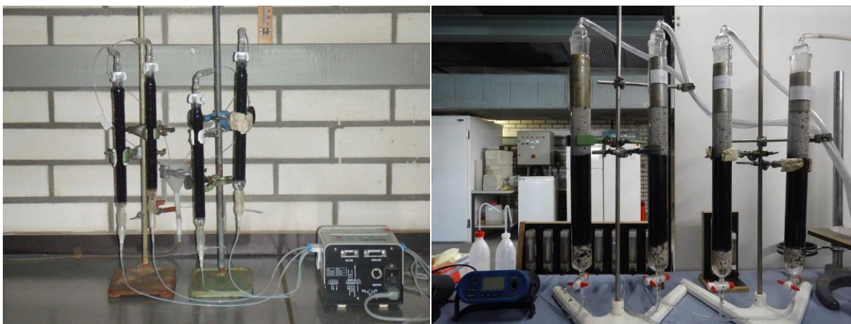
Abb. 3: Versuchsaufbauten der TU München: Bestimmung der Sorptionskapazitäten (links) und weitergehende Untersuchungen in Säulen (rechts)
