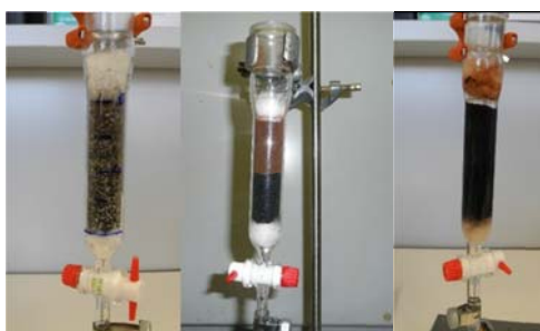
Abb. 1: Einzelne Adsorbermaterialien sowie Materialkombinationen im Laborversuch (Sorptionsversuch in Kolonnen).
