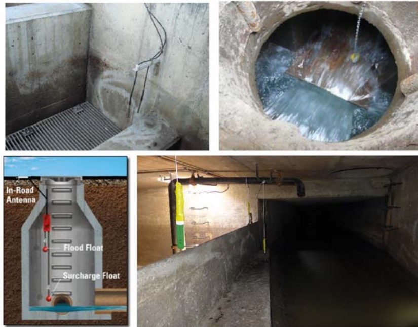
Abb. 1: Verschiedene Arten von preiswerten Sensoren für die Überwachung von Entwässerungssystemen. Von oben links im Uhrzeigersinn: i) elektrischer Schalter an Überlaufwehr (Rasmussen et al., 2008), ii) Bewegungsmelder am Überlauf (Siemers et al., 2011), iii) Bewegungsmelder (Eawag), iv) Flood float (www.123mc.com)
