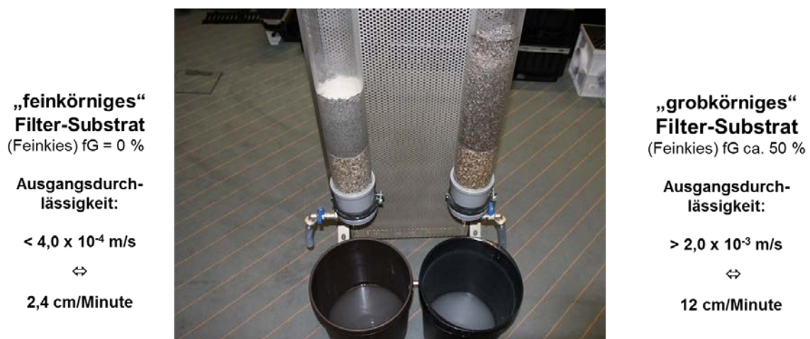
Abbildung 7: Oberflächenfiltration und Tiefenfiltration
