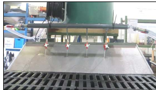
Abbildung 4: Versuchsstand und Beschickung der Filterrinne [Fotos: E. Dobner]
