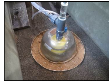
Abbildung 2: Ausflussmesszylinder, Ringinfiltrometer, Haubeninfiltrometer (v.l.n.r.) [Fotos: R. Reiter, E. Dobner]
