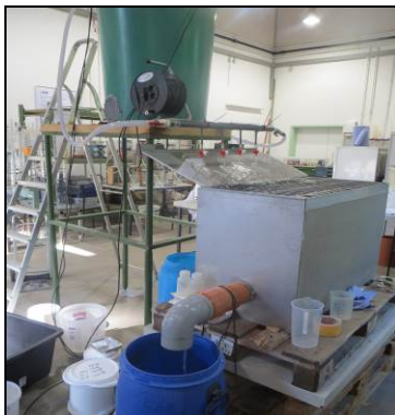
Abbildung 4: Versuchsstand und Beschickung der Filterrinne [Fotos: E. Dobner]
