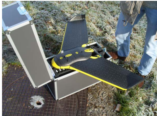
Abbildung 1: Ebee-Drohne (Sensefly), die in der Arbeit verwendet wurde
