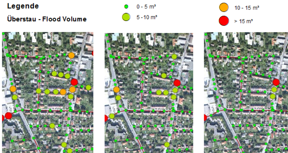
Abbildung 6: Vergleich der derzeitigen hydraulischen Leistungsfähigkeit des Entwässerungssystems bei einem 5-jährlichen Modellregen (linke Abbildung) mit der Ausschöpfung des theoretischen Abkoppelungspotenziales (Abbildung in der Mitte) und dem maximal möglichen Abkoppelungspotenzial (rechte Abbildung).
