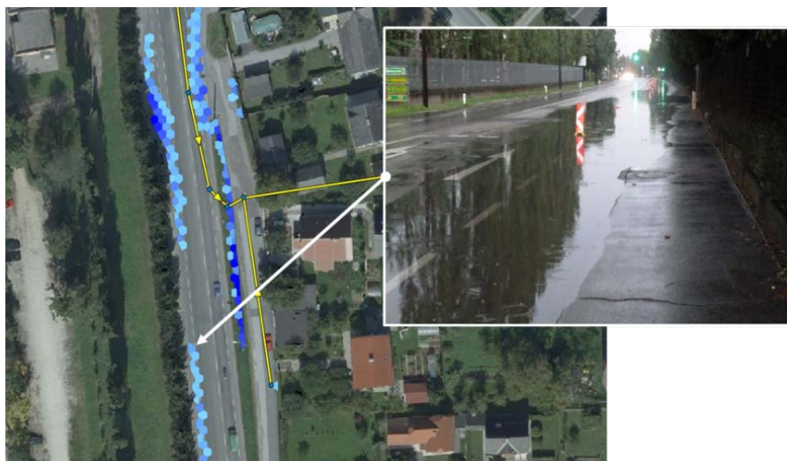
Abbildung 4: Beispiel für die Validierung der Modellergebnisse des 1D-2D Modells mittels Foto-Dokumentation; links sieht man das Simulationsergebnis, rechts die Situation vor Ort, der weiße Pfeil markiert die Stelle, an der das Foto gemacht wurde.
