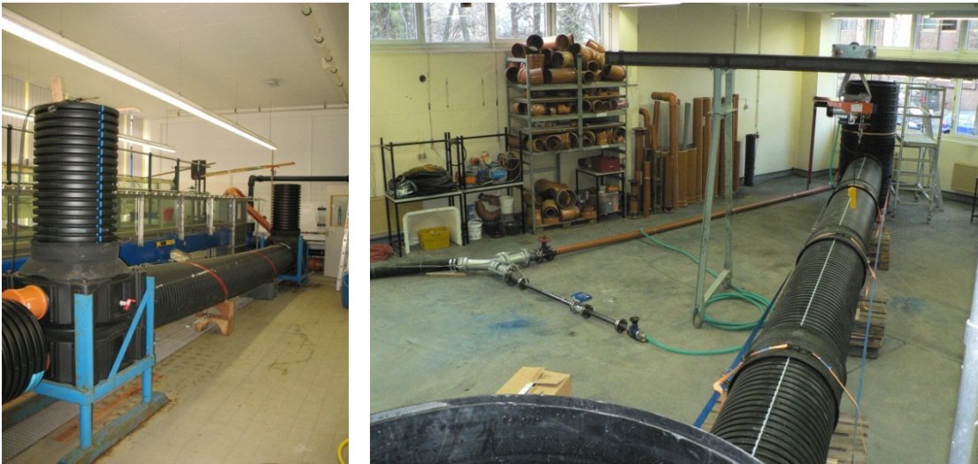
Abbildung 3 Originalanlage einer SediPipe® (li 6m Anlage, re 12m Anlage) im Labor für die Prüfung aufgebaut
