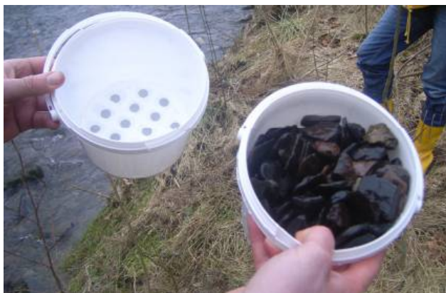
Abbildung 4: Sedimentfalle mit gereinigtem Ausgangssubstrat vor Einbau in die Gewässersohle
