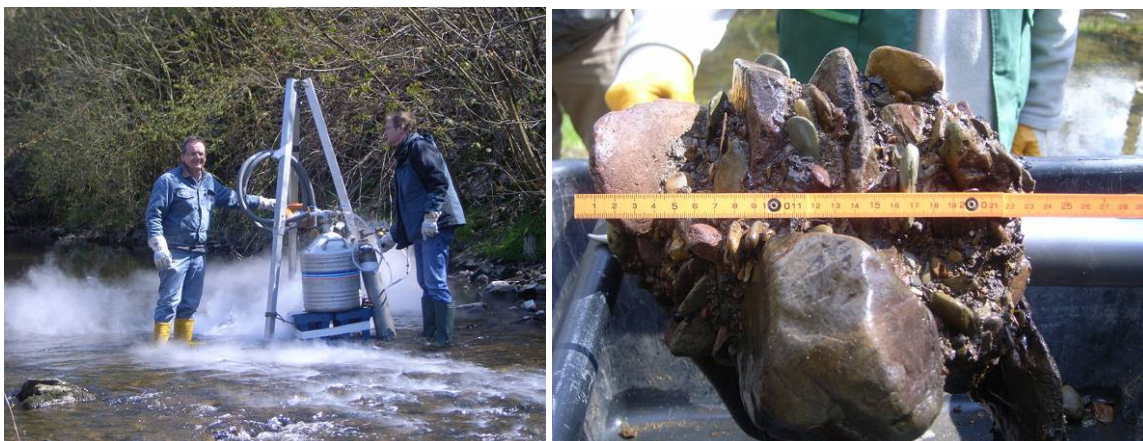
Abbildung 3: Gefrierkernentnahme und entnommener Kern
