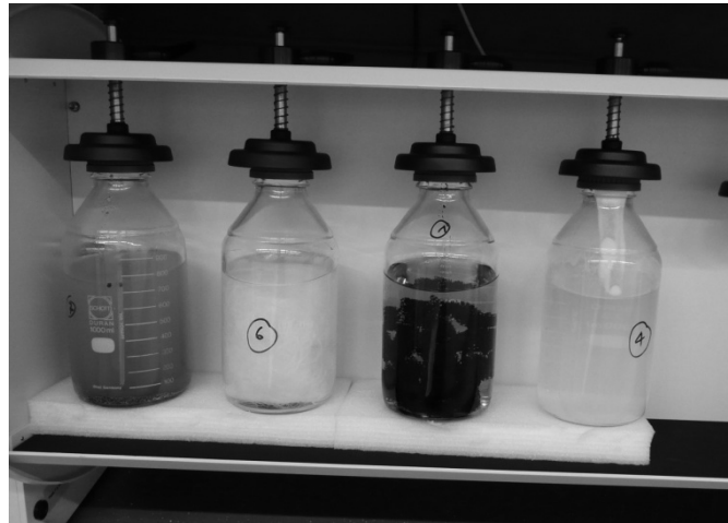
Abbildung 2: Adsorbentmaterialien im Laborversuch (Sorptionsversuch im Überkopfschüttler). Anschließend werden mit den besten Materialien Kolonnenversuche durchgeführt.
