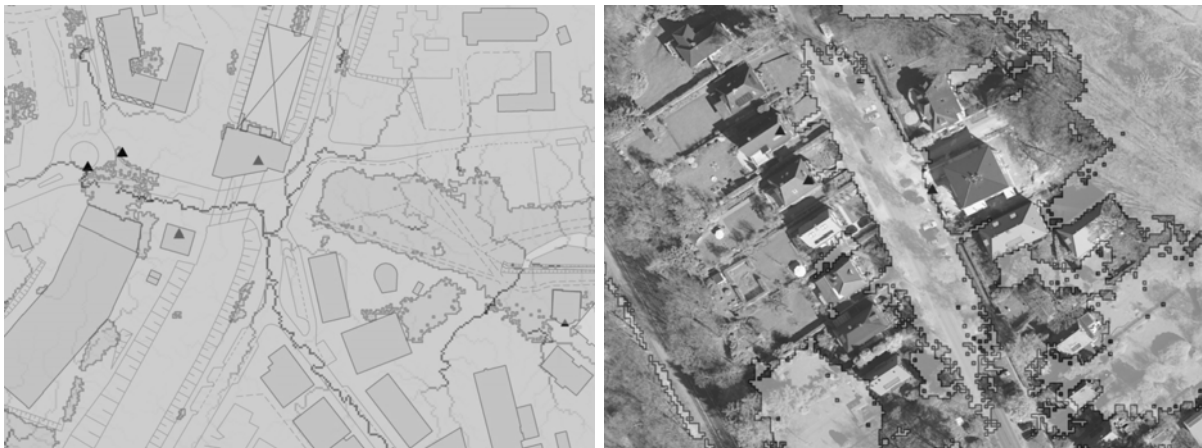
Abbildung 6: Fließweg- und Senkenermittlung mithilfe des Digitalen Geländemodells und Feuerwehreinsätzen für die Überflutungsprüfung, Quelle: HAMBURG WASSER 2011
