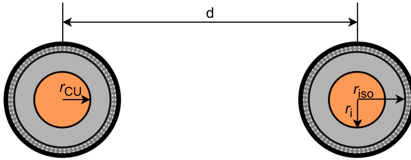
Abbildung 26: Verlegung des Kabelsystems mit Hin- und Rückleiter
