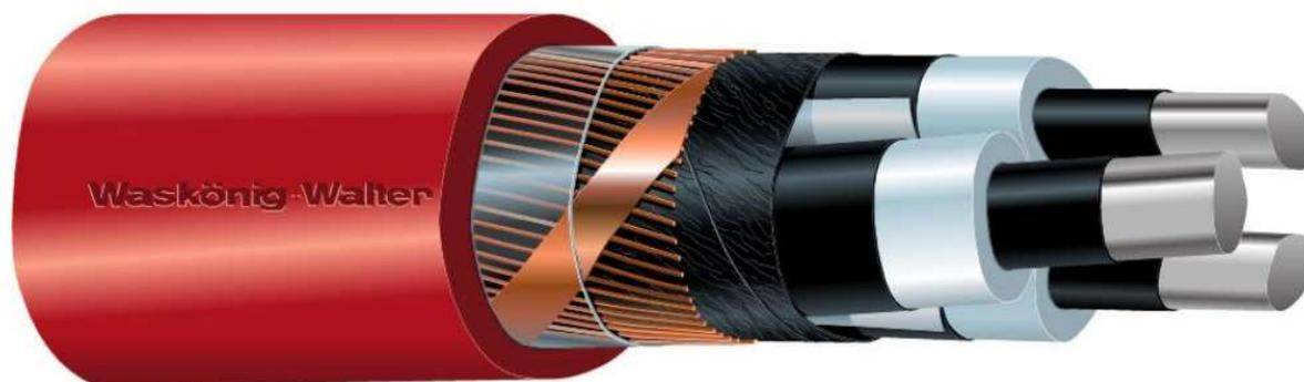
Abbildung 2.18: Mehrleiter Mittelspannungskabel PEX-S-AL 3X 95 SE/25 12 kV RT [31]
