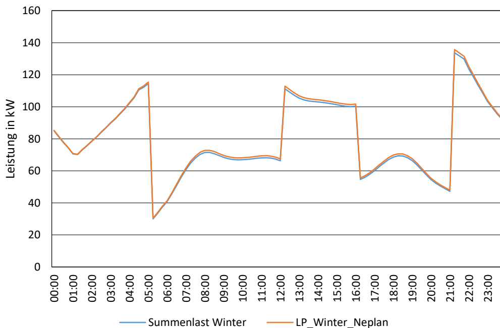
Abbildung 36: Verlauf der Last für Winter/Werktag bei Netz 2 ohne PV-LP
