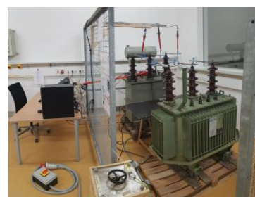
Abb.1 Laborversuch mit Leistungstransformatoren am IEAN
