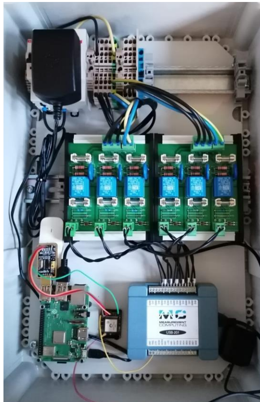
Abbildung 4: Prototyp des für die Ladestation konzipierten \mu PMU-Systems
