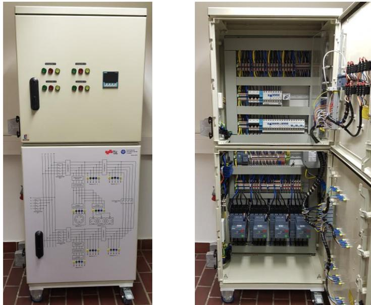
Abbildung 4.3: Realer Aufbau des Labordemonstrators, geschlossene Ansicht mit Bedienelementen und Buchsen für Messzwecke (links), offene Ansicht mit Sicherungseinbauten (rechts oben) und Leistungsschaltern samt Kommunikation (rechts unten)
