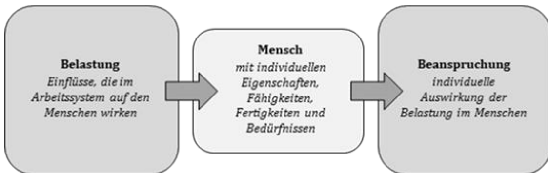
Abbildung 2: Das einfache Belastungs-Beanspruchungs-Konzept. Quelle: eigene Darstellung, in Anlehnung an [20].
