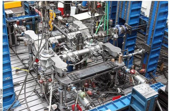
Betriebsfestigkeitsversuch eines Drehgestellrahmens
